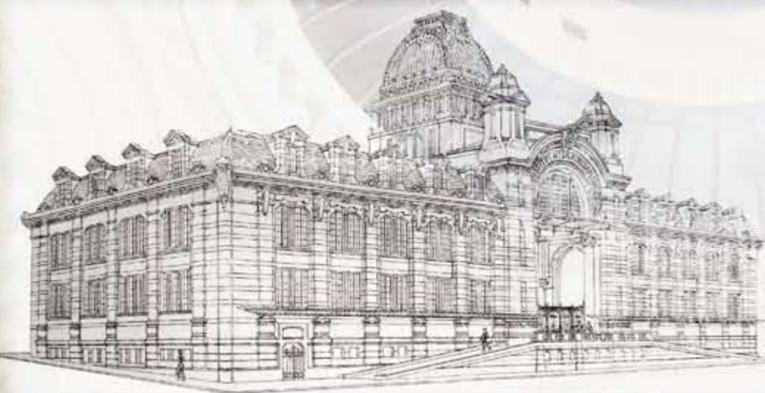
(Axonométrie) Descriptif : le bâtiment occupe la totalité d'un tènement trapézoïdal d'environ 66 m par 26 m, bordé par le quai Albert-Besson au Nord, côté lac. Au centre de la composition, le hall central surmonté d'une coupole et d'un dôme sur tour-lanterne culmine à plus de 30 m au-dessus du niveau du lac. De part et d'autre, deux cours symétriques en U se développent autour des cours couvertes sur deux étages et un comble.
